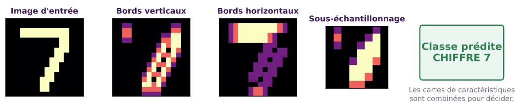
Figure 13. Démonstration visuelle d'une convolution. Des filtres simples font apparaître séparément les bords verticaux et horizontaux d'un chiffre ; le sous-échantillonnage compacte ensuite ces cartes avant la classification. Illustration originale reproductible du principe des CNN d'après LeCun et al. (1998) [8] ; code : scripts/generate_demo_figures.py .
