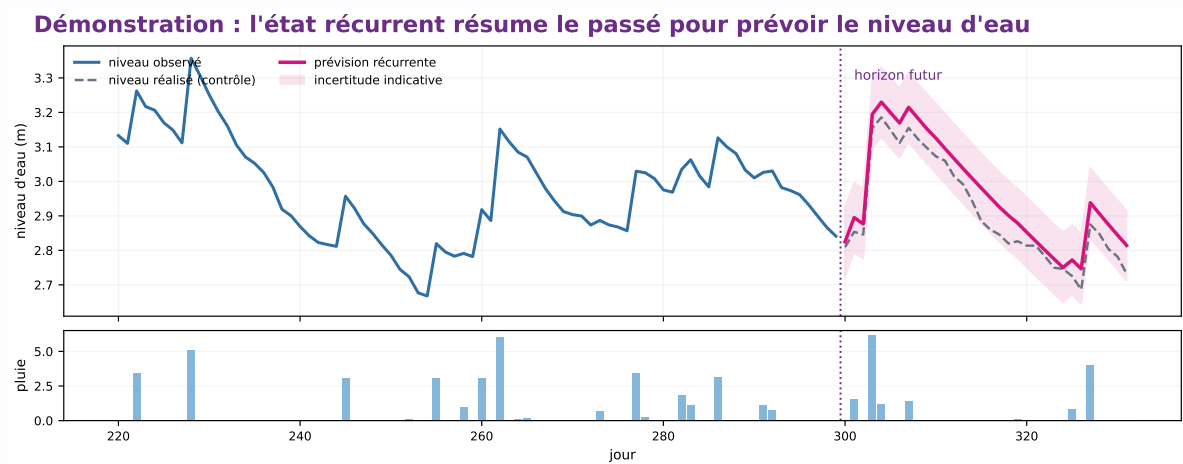
Figure 16. Démonstration reproductible de prévision temporelle. Un prédicteur récurrent minimal apprend sur une série synthétique de niveau d'eau influencée par la pluie et la saison, puis prévoit 32 jours par récurrence. La courbe grise, masquée au modèle, permet de contrôler la prévision ; les pluies futures sont supposées connues, comme dans un scénario alimenté par des prévisions météorologiques. Illustration originale (graine 19) du principe des RNN/LSTM [9] ; code : scripts/generate_demo_figures.py .
